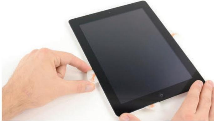
19. Cogemos el marco despegado de la parte derecha del iPad y empujamos hacia atrás (con una mano en la parte inferior derecha y otro en la parte superior derecha). Si quedan adhesivos, cortadles con una iFixit Guitar.
