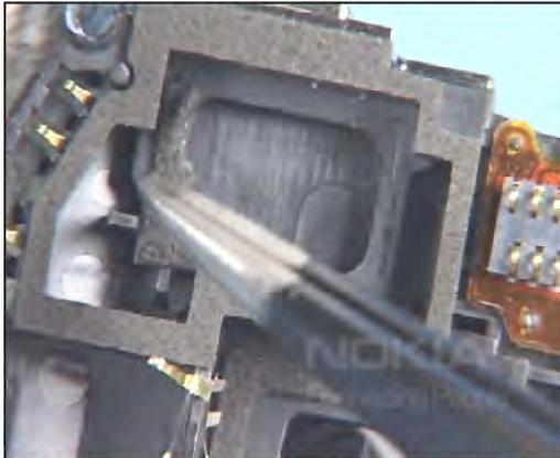
27. El soporte del auricular tiene que ser destruido. Remueva todos los residuos y limpie bien la placa antes del armado del móvil.
