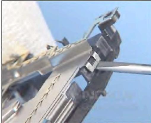
28. Desde lass trabitas, tire hacia arriba para desprender la protección metálica (BB shield).
