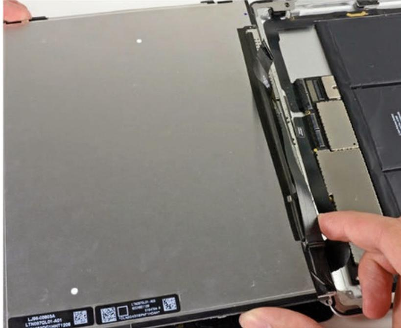
28. **iPad 2:** Retiramos el **conjunto del panel frontal**. El cable que hemos quitado tendrá que deslizarse al mover la pantalla. Levantamos la pantalla hacia arriba deslizando suavemente el panel frontal lejos del iPad. Hay que tener cuidado de no enganchar el cable digitalizador en la pantalla o la caja trasera.
