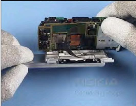
15. Separe la tapa de ensamblado teniendo mucho cuidado, ya que hay un flexible conectado a la otra parte del móvil.
