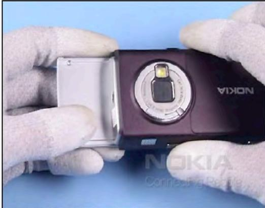
7. Desplace el deslizador del teléfono hacia la otra posición.
