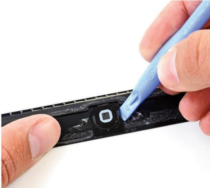
35. iPad 3: En la parte que hemos quitado, la parte frontal, **está el Botón Home**, para facilitar el reemplazo, **calentamos el iOpener** en el microondas y lo colocamos en la parte inferior del marco frontal para reemplazar el Botón Home.
