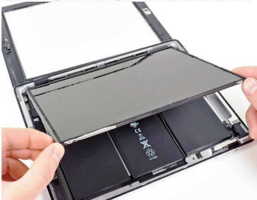
29. **iPad 3:** Si es necesario, quitamos la cinta adhesiva que sujeta el cable de cinta digitalizador. Levantamos la solapa de retención de la cinta ZIF del cable digitalizador.
