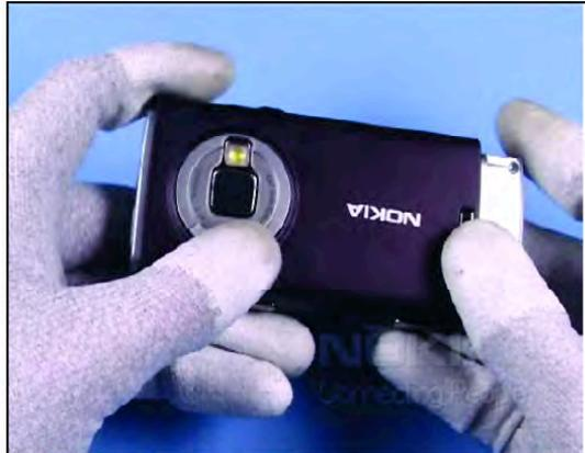
4 Desplace la tapa de ensamblado.
